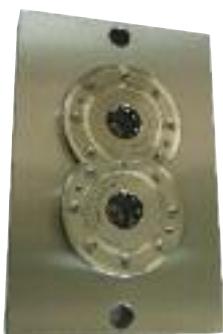
Collegamento rigido alla piastra di base con i cilindri punto zero Connexion to Zeropoint Quickclamping station Zu den Nullpunktschnellverschluss Connexion à la station de serrage rapide point zéro
